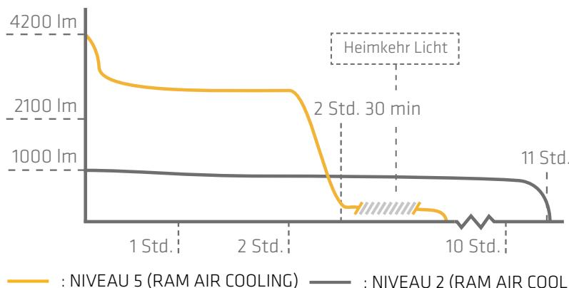
— : NIVEAU 5 (RAM AIR COOLING) — : NIVEAU 2 (RAM AIR COOLING)
